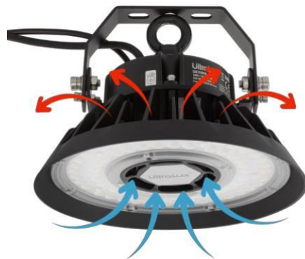
Orificio transitorio central de ventilación (autorefrigeración)
